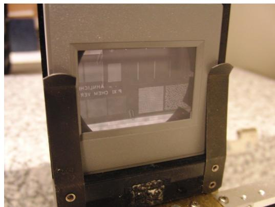
Das Gitter wird in einem Kreuztisch- Halter frei verschiebbar in einen Versuchsaufbau so eingesetzt:
