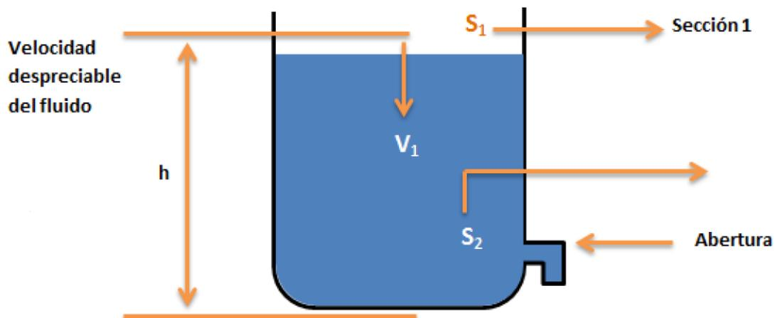
Con el teorema de Torricelli se puede calcular el caudal de salida de un líquido por un orificio
