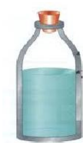
Fig.7.21 Frasco Dewar (Termo). El vacío evita pérdidas de calor por convección y conducción; las superficies reflejantes evitan pérdidas por radiación.
