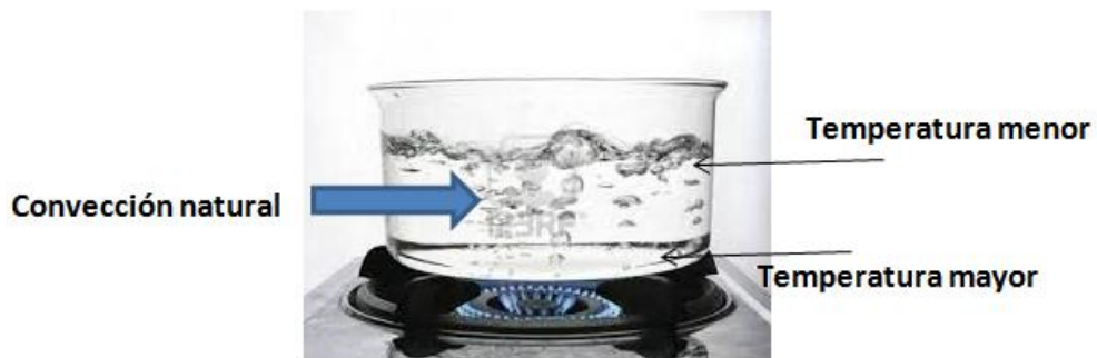
Fig 7.16. Movimiento por convección natural durante la ebullición del agua.
