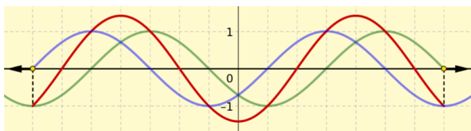
Obr. 3: Vznik stojaté příčné vlny interferencí dvou stejných vln jdoucích proti sobě.
