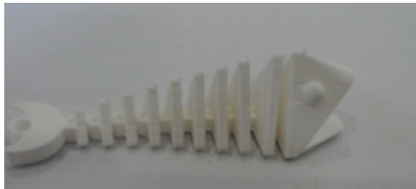
Figura 15. Prototipo de señuelo plástico impreso en 3D.
