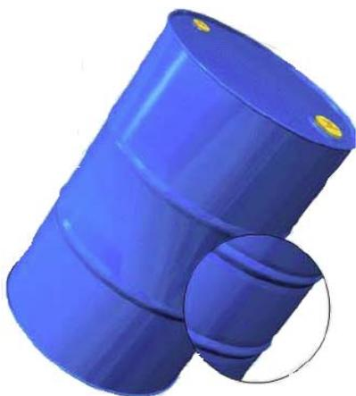
Los tambores para aceites pueden ser fabricados en dos modelos básicos que se diferencian en el diámetro: “Convencional”, con un diámetro máximo de 595 mm o **Spiraltainer®** que permite la paletización y modula perfectamente en el ancho de contenedor de transporte marítimo (80 tambores/contenedor 20’), al reducir el diámetro máximo del tambor a 585 mm. Ambos tipos se pueden entregar con o sin corrugaciones dependiendo del espesor del cuerpo:
