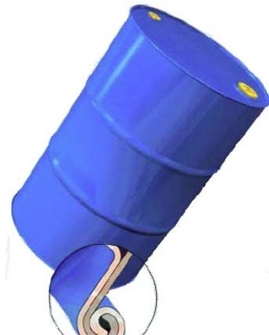
Los espesores de acero más utilizados para el envase de aceites va entre 0,7 hasta 0,9 mm o combinaciones de estos espesores, de acuerdo básicamente a la automatización disponible en los sistemas de llenado, almacenamiento y distribución del producto. Los tambores más delgados están provistos de corrugaciones para aumentaren algo la resistencia a las abolladuras.
