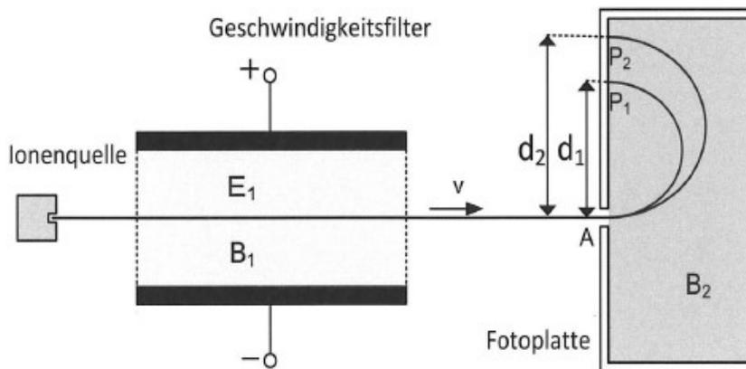
Die Ionen durchlaufen das Geschwindigkeitsfilter ohne Ablenkung.
