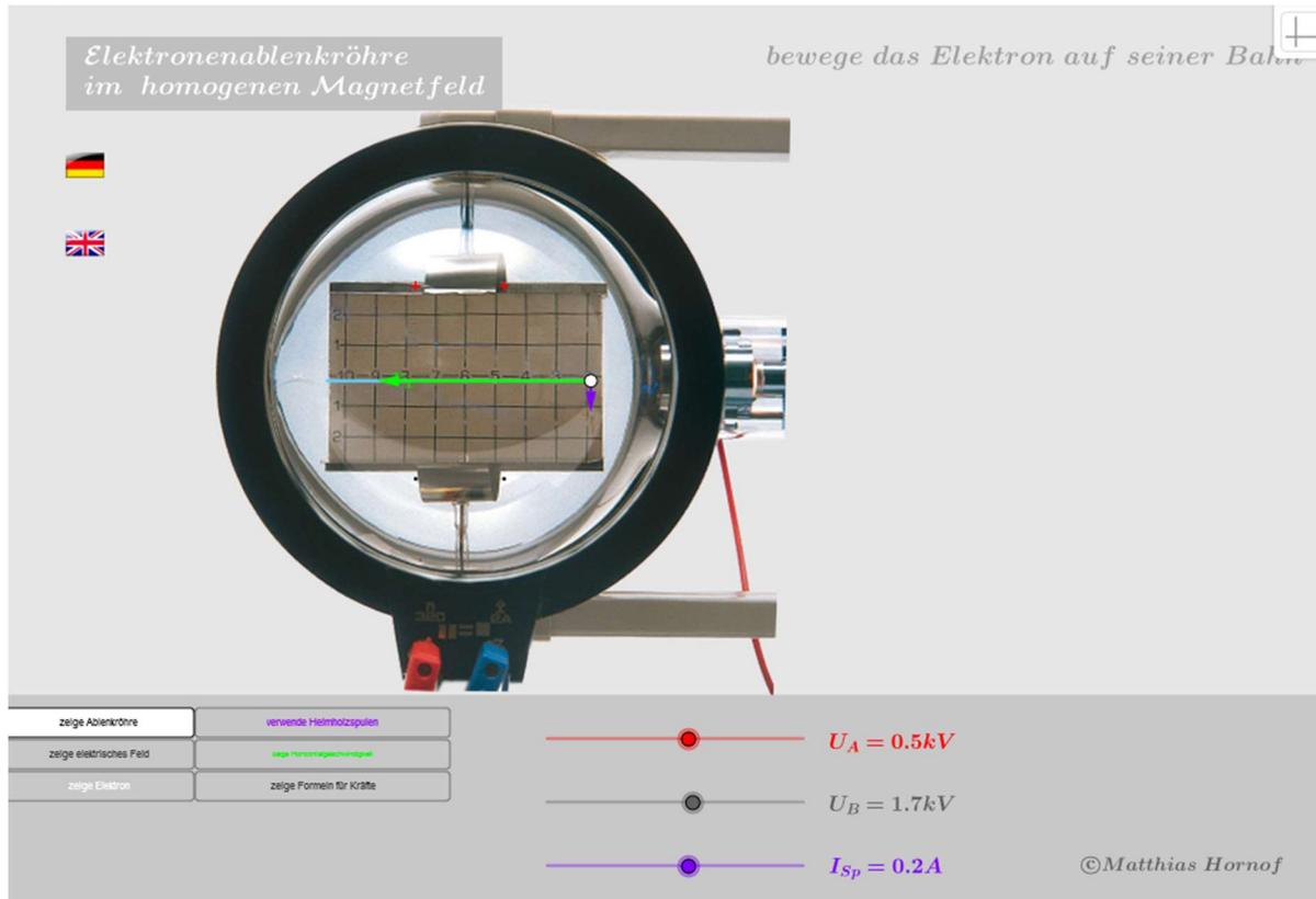
Öffnen Sie die Datei „ABElektronenablenkröhre.ggb“. Sie sehen den Aufbau einer Elektronenablenkröhre mit den waagrecht liegenden Kondensatorplatten und einem Koordinatensystem.
